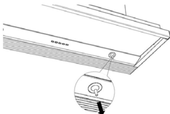
Mit der Dunstabzugshaube wurde ein kleiner Saugnapf zum Herausnehmen der Lampen mitgeliefert. Ziehen Sie das Leuchtmittel mit dem mitgelieferten Saugnapf vorsichtig nach unten heraus und setzen mit dem Saugnapf eine neue Lampe ein.
