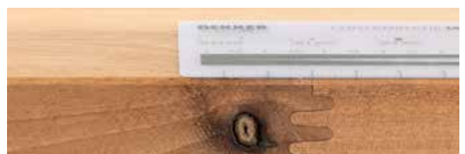
Oppervlakteverstoring: voelbare knoesten of noesten in het oppervlak
