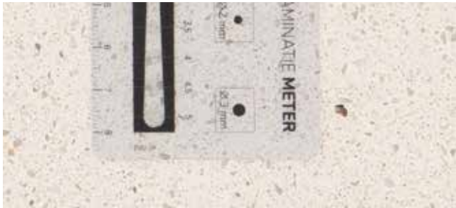
Contaminatiespot: kleine vlek in een afwijkende kleur
