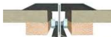
Koppelingverbinding met bouten met WK4 randafwerking
